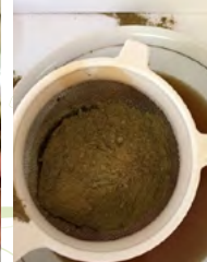
الصورة 42- غربلة المسحوق
